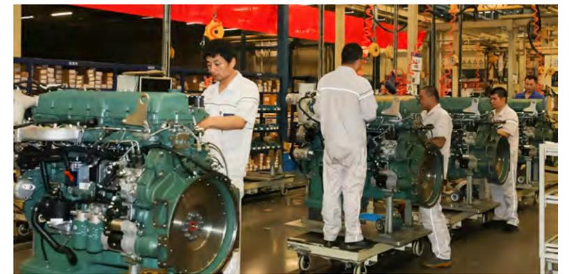
工人进行再制造发动机基础检测
